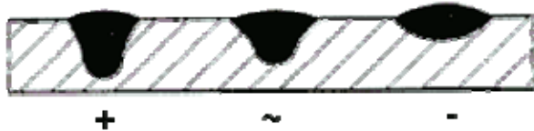
Figuur 4 Invloed van de polariteit van de draad op de vorm van de lasdoorsnede.
