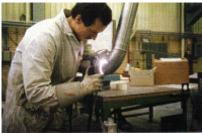
Foto 3: Het lassen van een titaanleiding met een speciaal aangepaste TIG-toorts met 'gasslof' bij Schelde Exotech BV te Vlissingen.
