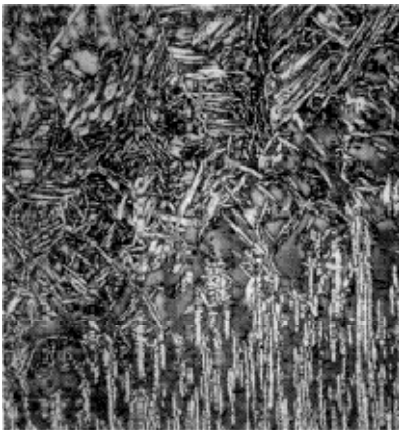
Figuur 2. Grovere korrel in de warmte-beïnvloed zone van ferritisch roestvast staal.
