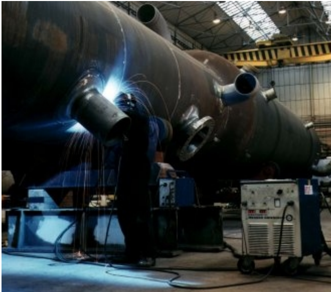
Figuur 1. Het lassen in de praktijk aan een nikkel legering.
