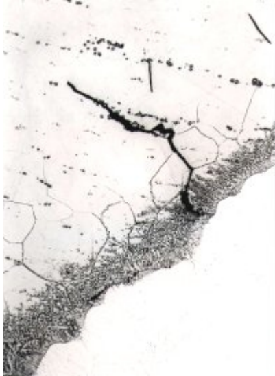
Figuur 2. Microscheur in overgang en plaatmateriaal.
