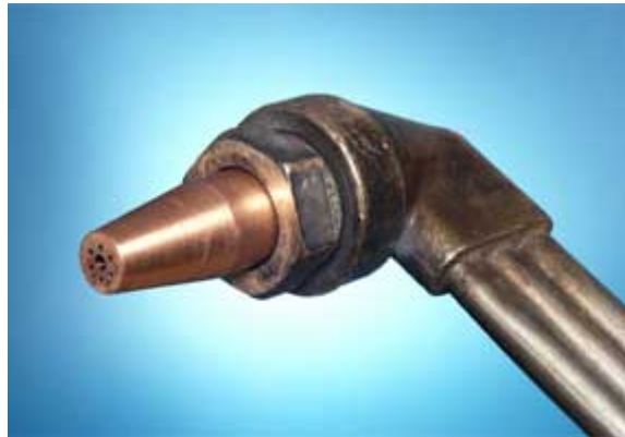
Fig. 2: Standaard mondstuk uit één stuk, met boringen voor de voorwarmvlam en het centrale zuurstofkanaal voor de snijzuurstof
